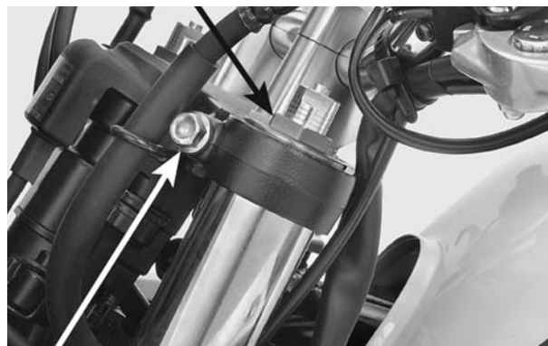
PARAFUSO DE FIXAÇÃO DA MESA SUPERIOR FIAÇÃO DA BUZINA
