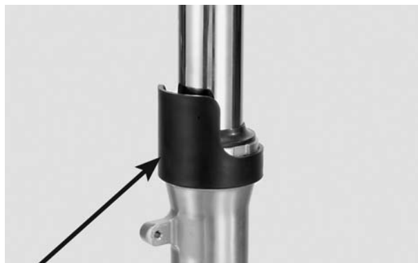
PROTETOR DO GARFO DA SUSPENSÃO PARAFUSO SUPERIOR DO GARFO DA SUSPENSÃO
