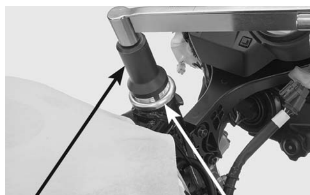
SOQUETE PARA COLUNA DE DIREÇÃO
