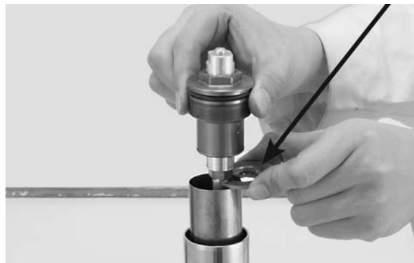
CARCAÇA DO AMORTECEDOR (AJUSTADOR DE PRÉ-CARGA)
