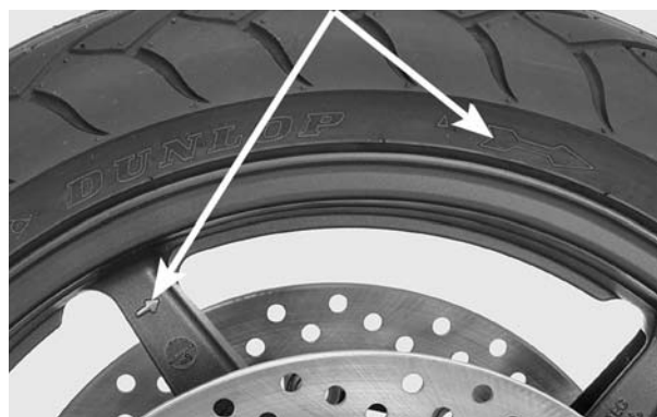
VÁLVULA MARCAS DE SENTIDO DE ROTAÇÃO
