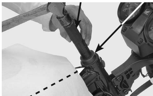
PISTA EXTERNA SUPERIOR PISTA EXTERNA INFERIOR
