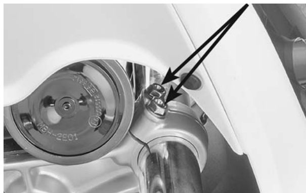
PARAFUSO DE FIXAÇÃO DA MESA SUPERIOR PARAFUSOS DE FIXAÇÃO DA MESA INFERIOR
