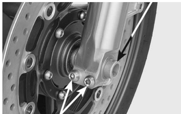
PARAFUSOS DE FIXAÇÃO ESPAÇADOR LATERAL DIREITO
