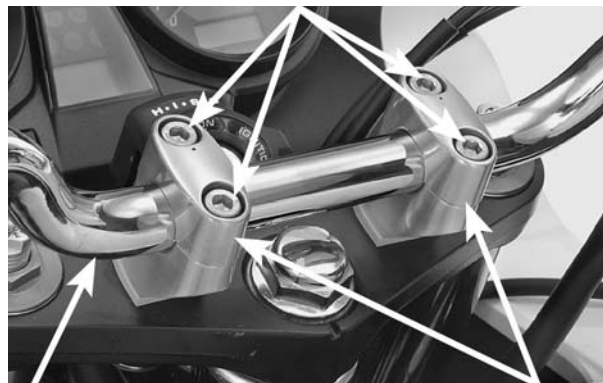
GUIDÃO INTERRUPTOR DIREITO DO GUIDÃO SUPORTES SUPERIORES EXTREMIDADES DO CABO
