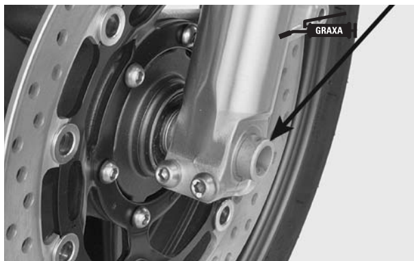
ESPAÇADOR LATERAL ESQUERDO EIXO
