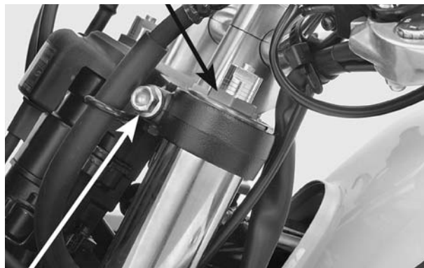
PARAFUSO DE FIXAÇÃO DA MESA SUPERIOR PARAFUSOS DE FIXAÇÃO DA MESA INFERIOR
