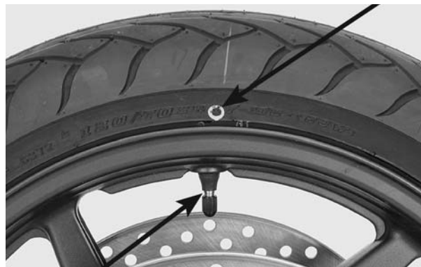
VÁLVULA MARCAS DE SENTIDO DE ROTAÇÃO
