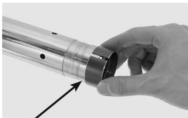
BUCHA DO CILINDRO INTERNO RETENTOR DE ÓLEO BUCHA DESLIZANTE
