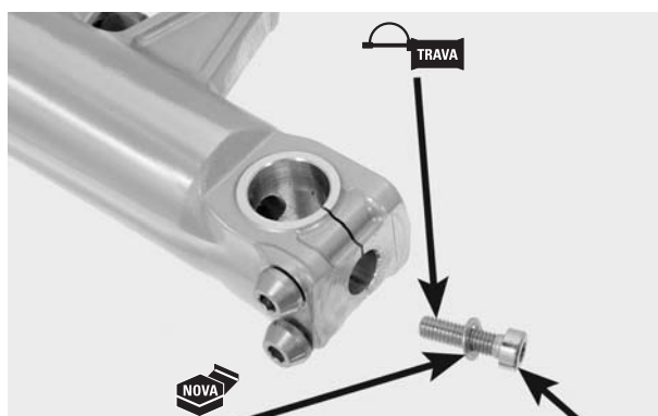
ARRUELA DE VEDAÇÃO PARAFUSO ALLEN DO GARFO DA SUSPENSÃO
