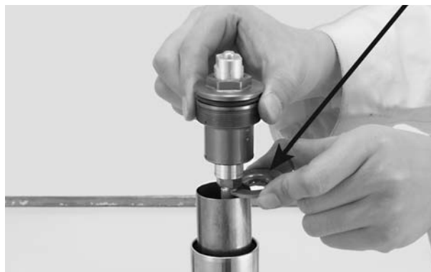
PARAFUSO SUPERIOR DO GARFO DA SUSPENSÃO PLACA DE CONEXÃO
